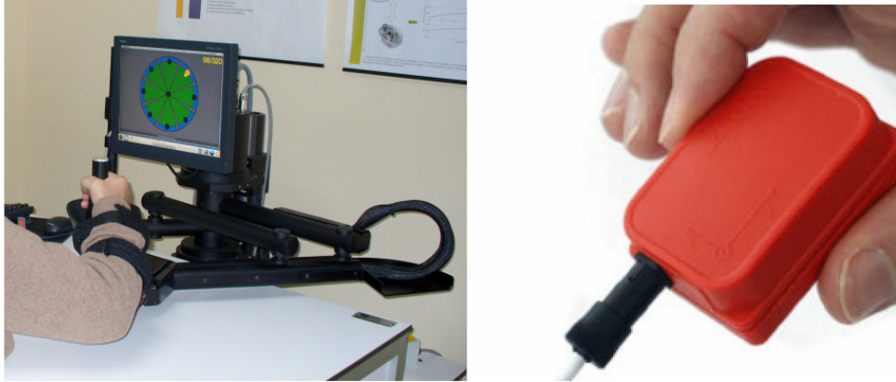
Figure 6. MIT Manus robot arm and Xsens magneto-inertial unit
