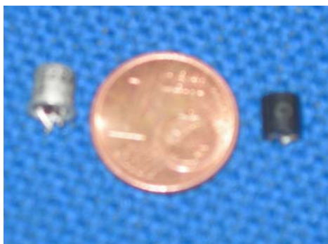
Fig. 2.2. Foto dei package dei due transistor utilizzati.
