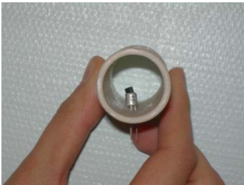
Fig. 2.4. Posizionamento all'interno dell'alloggiamento cilindrico dei due transistor. Si notano le differenti caratteristiche dei package dei due transistor.
