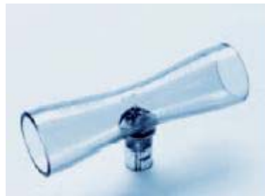
Fig.1.11. Anemometro a filo caldo utilizzato in ventilazione polmonare.
