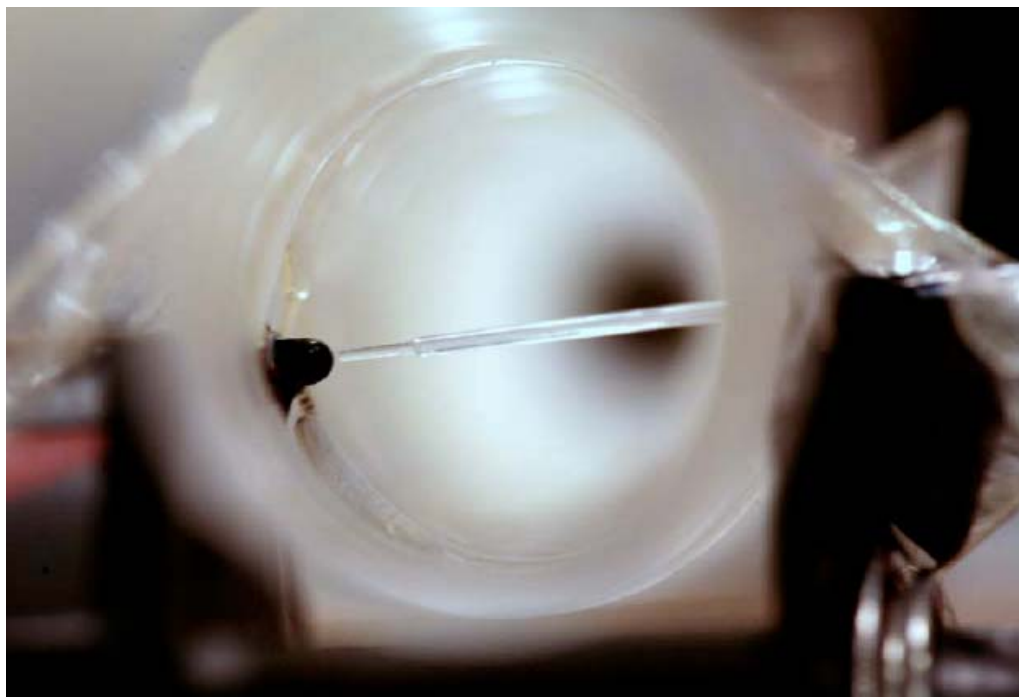
Fig. 2.65. Posizionamento della fibra perpendicolarmente al fototransistor per la misura di I_{CO} .
