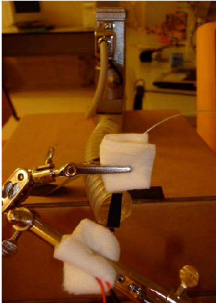
Fig. 2.68. Set up sperimentale con la fibra che presenta maggiore resistenza al gas che la investe per la presenza di una lastra di un altro materiale.
