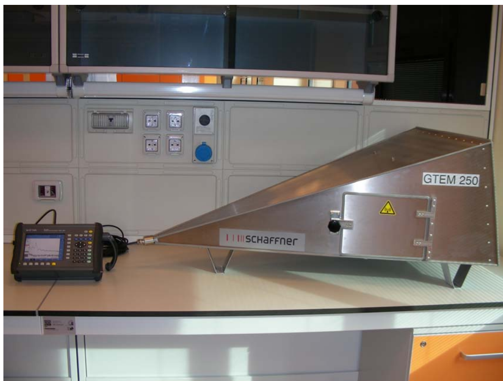
Figura 43: Set-up di misura: a sinistra l'analizzatore di spettro Willtek; a destra la cella GTEM 250 Schaffner
