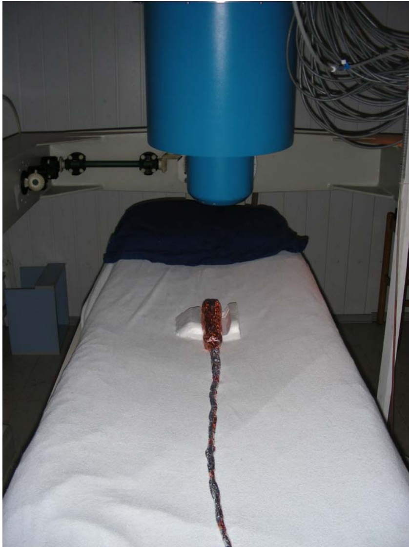
Figura 64: Dettaglio del motore brushed in ambiente MEG dopo la schermatura con una lamina di alluminio di 0,5 mm di spessore.
