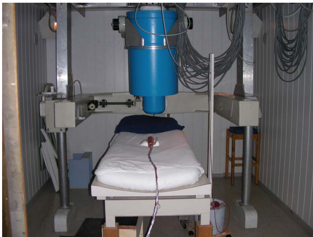
Figura 59: Set-up di misura in ambiente MEG (motore brushed con schermatura)
