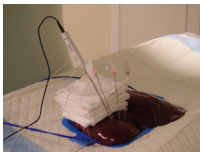
Fig. 7.40: Fegato di maiale con ago elettrodo RF e termocoppie
