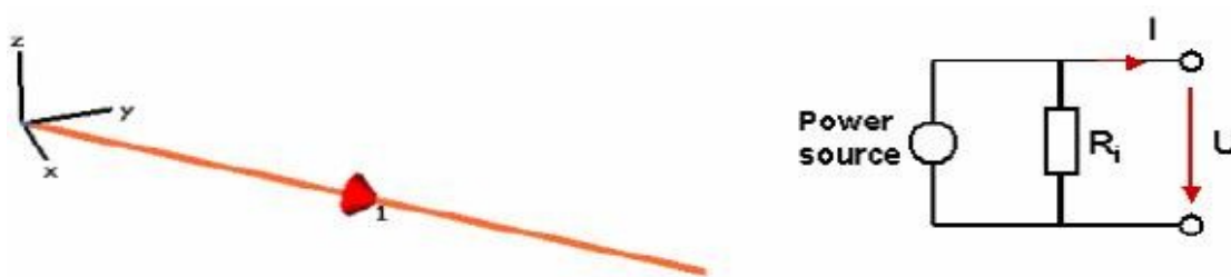
Fig. 6.20: Modello equivalente della porta discreta "S-parameter"
