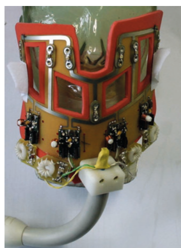
Figura 22: Bobina dedicata all'imaging dei denti in sperimentazione (NORAS, Hochberg, Germany)
